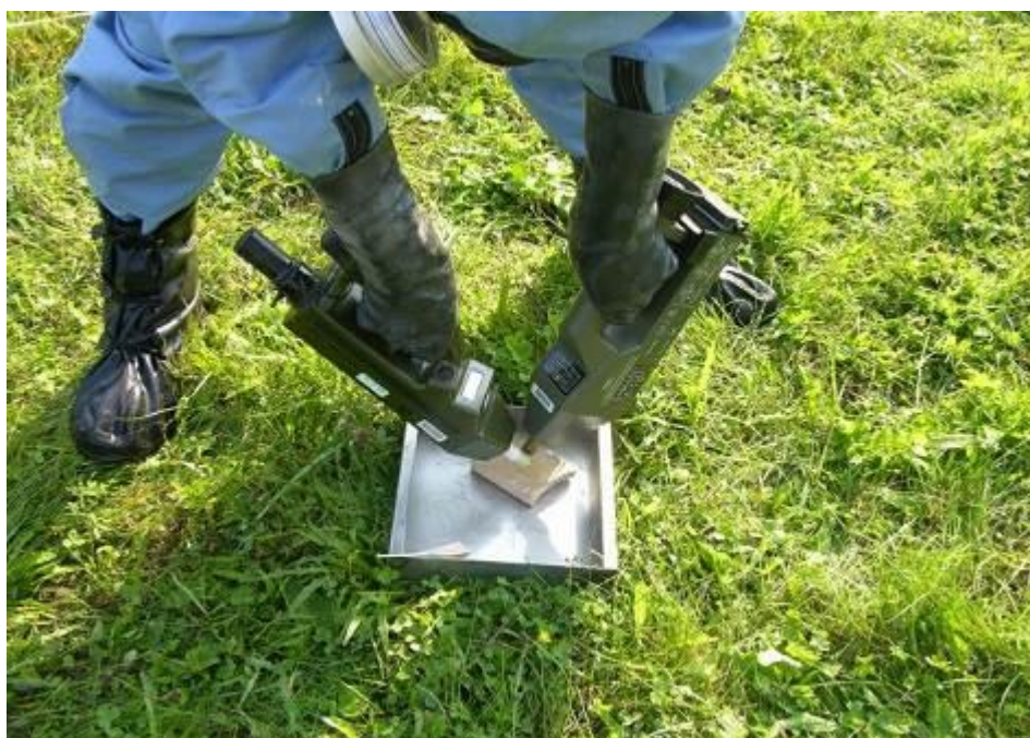
Figure 2.2 : Inspecteur de l'OIAC utilisant deux détecteurs de technologies différentes pour obtenir une identification "confirmée" pendant un exercice de formation en République tchèque, 2008
