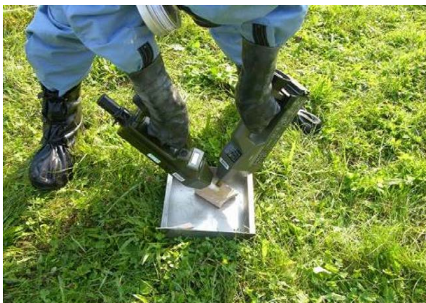
Figura 2.2: Inspector de la OPAQ durante un ejercicio de entrenamiento en la República Checa, en 2008, utilizando dos detectores con diferentes tecnologías para obtener una detección “confirmada”.
