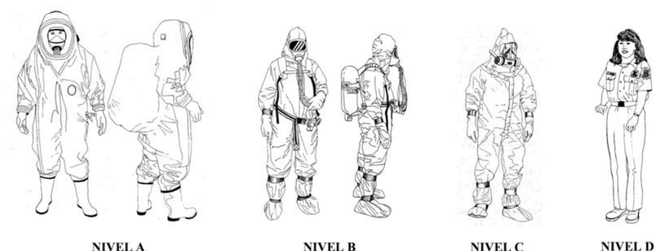
Figura 2.3: Niveles de los EPP según la Agencia de Protección de Medio Ambiente de EEUU (US EPA)
