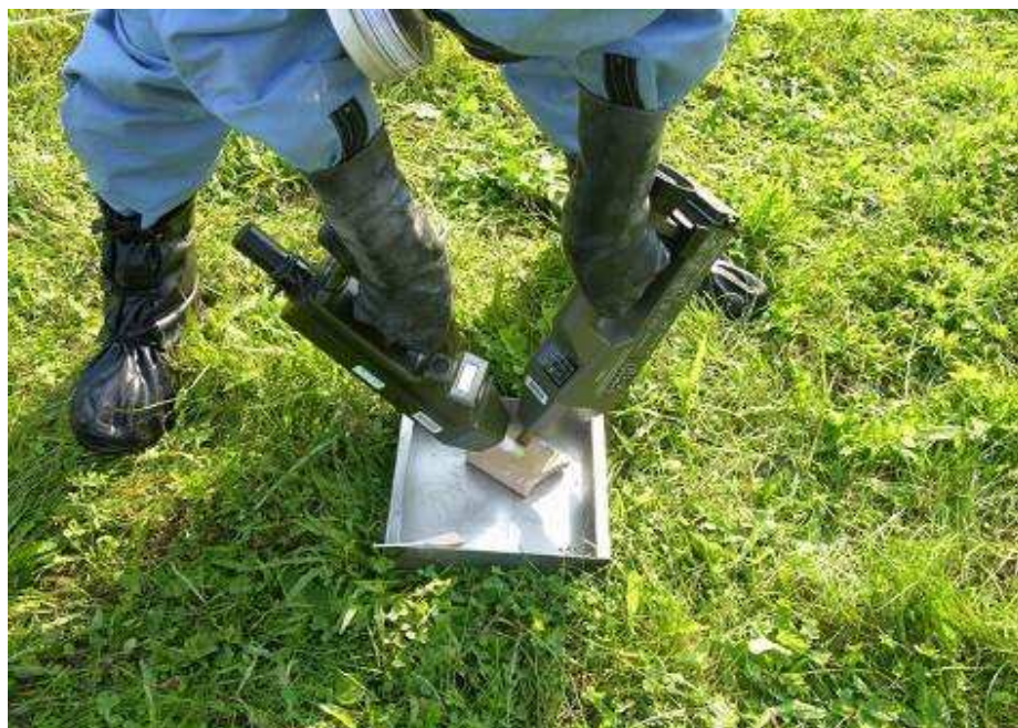
Abbildung 2.2 OPCW-Inspektor bei einer Übung in der Tschechischen Republik bringt zwei verschiedene Detektionsmethoden zur Anwendung, um ein „verlässliches“ Ergebnis zu erhalten.
